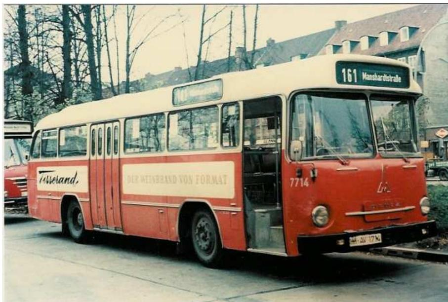
Die letzte Saturn II-Serie von Typ Hamburg der HOCHBAHN, jetzt als M 150 S 10 bezeichnet, hatte bereits einen Fahrtzielbandkasten in Abmessungen gemäß VÖV-Vorgaben. Foto: E. Ihde/HOV
