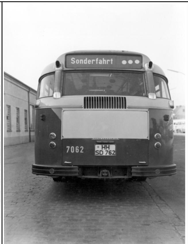
Heckansicht Saturn II „Typ Hamburg“ Wagen 7062: Große Fahrtzielanzeige, hochgezogene Auspuffrohre, separate Brems- und Rückleuchten, Wechselblinker.
