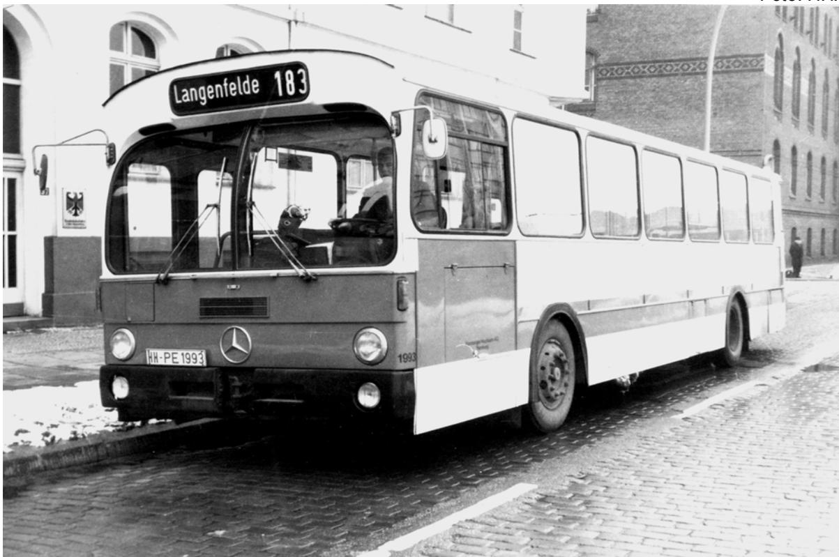
Bei der ersten und zweiten Serie des O 305 von Daimler Benz war die Dachkante optisch noch nicht vorteilhaft ausgeführt. Im Gegensatz zu den anderen Herstellern verzichtete Daimler Benz auf Aluminium-Verblechungen und Konservierungsmassnahmen, so dass schnell einsetzender Rostfraß zu Korrosionsschäden führte.
