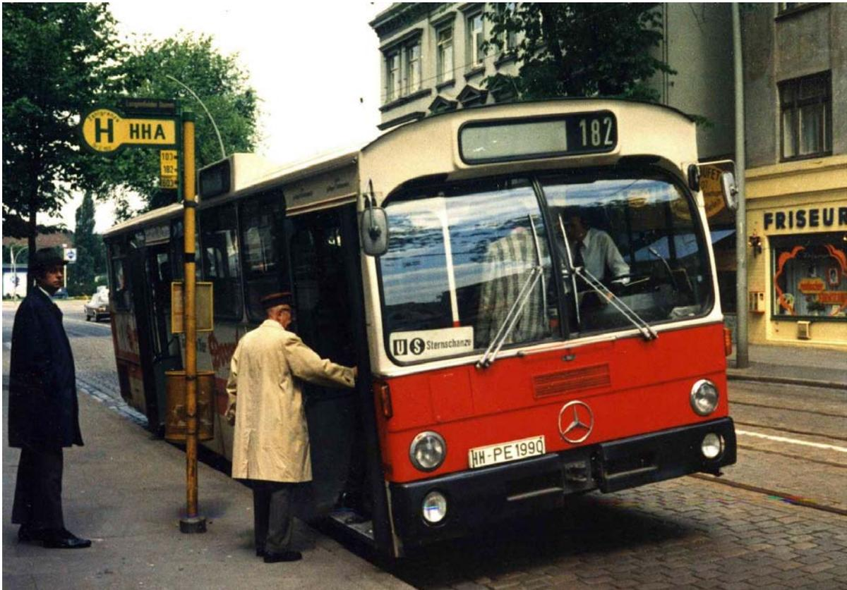
*Kneeling war noch nicht! Der Umstand, dass der Fahrgast am 03.06.1973 an der Hst. Langenfelder Damm nahezu höhengleich in den Wagen 1990 einsteigen kann, ist auf eine schadhafte Luftfederung und das gewölbte Straßenprofil zurückzuführen.*
